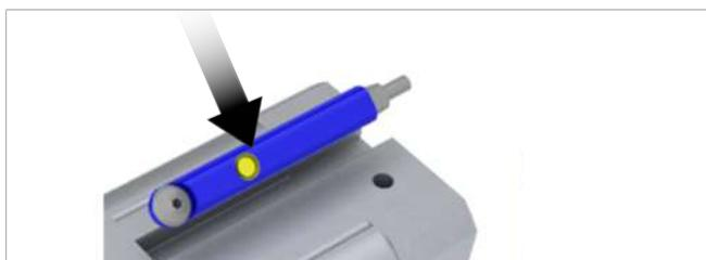
2. Sensor bis zum Anschlag der T-Nut schieben bzw. bei Varianten mit **offener T-Nut** den Sensor bündig mit dem unteren Nutende (zur Greiffläche hin) fixieren.
