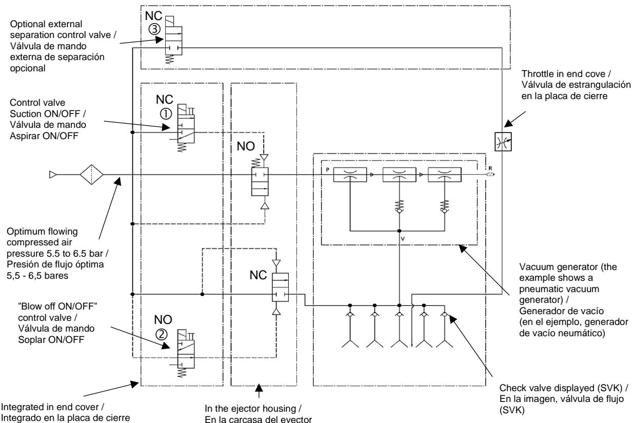
FXP-S-SVK with optional separation function, includes throttle. Optional 3/2-way valve FXP-S-SVK con función de separación opcional, incl. válvula de estrangulación. Válvula opcional de 3/2 vías
