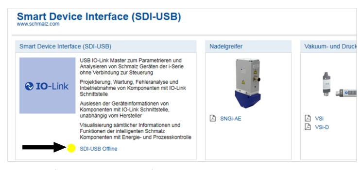
1. Cuando el software se inicia, aparece la interfaz de usuario que se muestra aquí. El indicador de estado muestra un punto amarillo si no hay ninguna conexión con un dispositivo habilitado para IO-Link.
