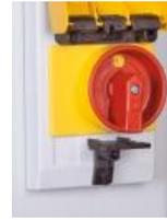
⇒ Posizionare e mantenere la manopola (**JUMBOERGO**), la manopola di regolazione (**JUMBOSPRINT**) e la leva di azionamento (**JUMBOFLEX**) su "Distacca" per evitare un sollevamento del sollevatore tubo a vuoto
