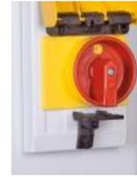
⇒ Coloque el mando giratorio (**JUMBOERGO**), el mando de regulación (**JUMBOSPRINT**) o el mando de accionamiento (**JUMBOFLEX**) completamente en la posición "Soltar" y manténgalo en esa posición para evitar que el tubo elevador por vacío se desplace hacia arriba de forma rápida.
