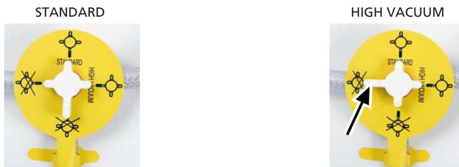
Dans le cas d'un fonctionnement à faibles pressions d'aspiration inférieures ou égales à 200 mbars, le débit d'aspiration de la pompe à vide peut être augmenté en commutant la vanne à 3 voies (27) sur la position HIGH VACUUM. Si les pressions d'aspiration sont supérieures ou égales à 200 mbars, la position de la vanne HIGH VACUUM peut entraîner la formation d'éclaboussures au niveau de la sortie de gaz (24).
