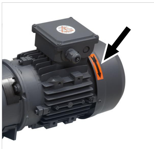
3. El dispositivo se entrega con «campo giratorio a derechas». Si el sentido de giro no es correcto, desconectar inmediatamente el dispositivo e intercambiar los polos de la conexión de la línea de alimentación.
