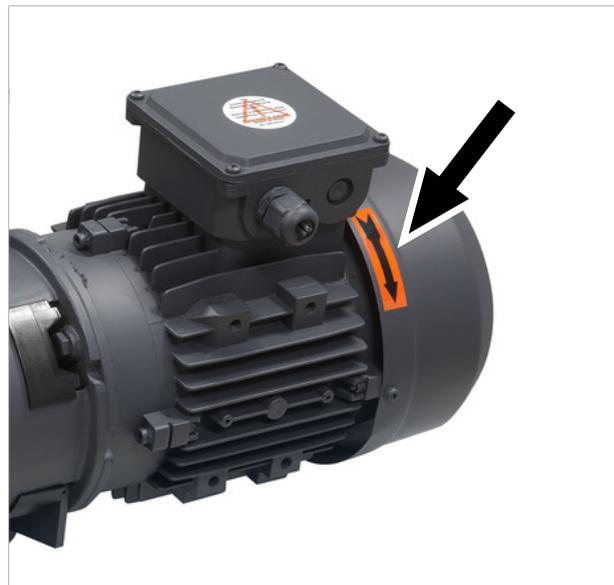
3. Das Gerät wird mit „Rechtsdrehfeld“ ausgeliefert. Bei verkehrter Drehrichtung sofort ausschalten und Anschluss in der Versorgungsleitung umpolen.
