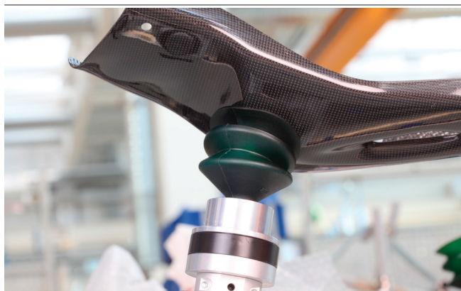
Uni-Base UB e Reference-Suction-Cup RSC per il bloccaggio di un pezzo CFK
