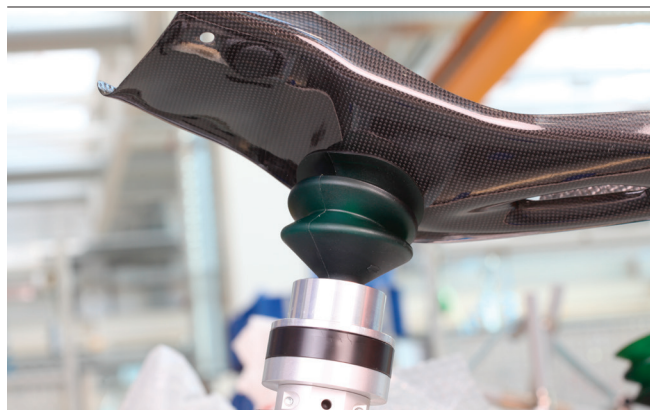
Uni-Base UB et ventouse de référence RSC lors du bridage d'un composant en PRFC
