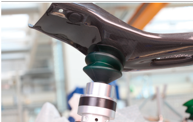
Uni-Base UB und Reference-Suction-Cup RSC beim Aufspannen eines CFK-Bauteils
