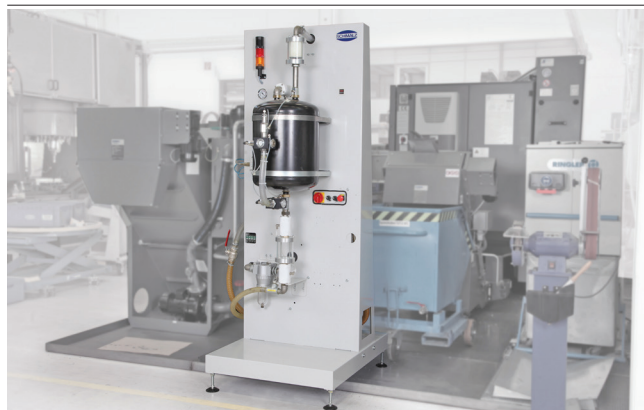
Vacuum Operation Center zur Vakuum-Erzeugung in der Nassbearbeitung
