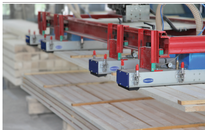
Sistemi di presa SBX-C su un portale industriale per la movimentazione di assi di legno segate ruvide
