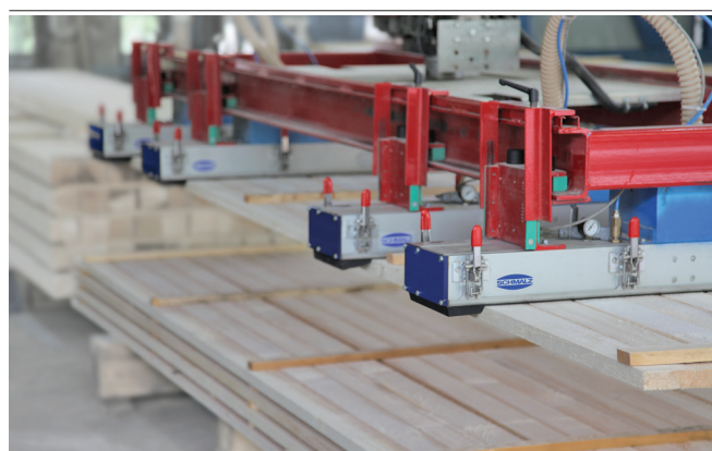
Greifsysteme SBX-C an einem Industriportal zur Handhabung von sägerauen Holzbrettern
