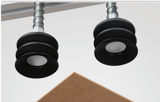
Ventouses à soufflets avec disques filtrants FD lors de la manipulation de panneaux en bois
