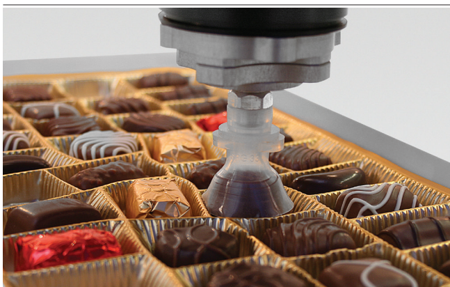
Ventosas para bombones SPG durante la manipulación de bombones
