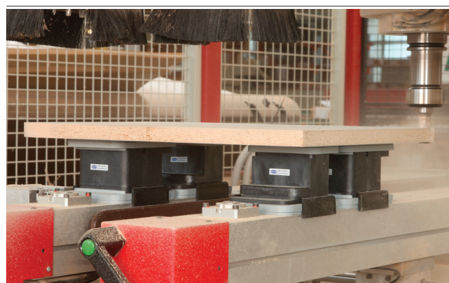
Blocco di aspirazione VCBL-K2 durante il bloccaggio di un pezzo in legno massello
