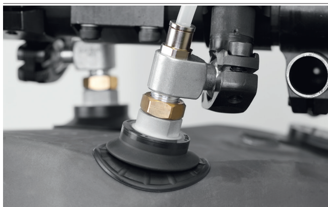
Ventouses à soufflets SAB HT2 lors de la manipulation des pièces des tôles
