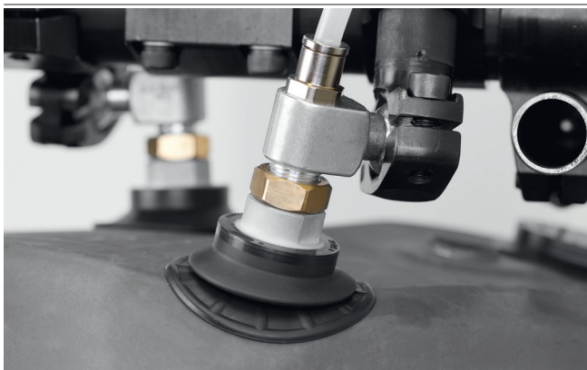
Balgsauggreifer SAB HT2 bei der Handhabung von geformten Blechen
