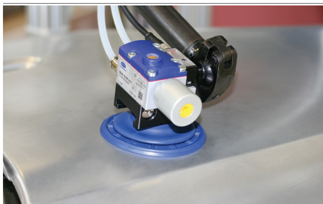
Génération du vide décentralisée par éjecteurs SEAC RP avec système de soufflage directement sur la ventouse
