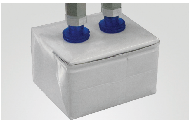
Ventosas de fuelle FG PVC durante la manipulación de cartones pequeños
