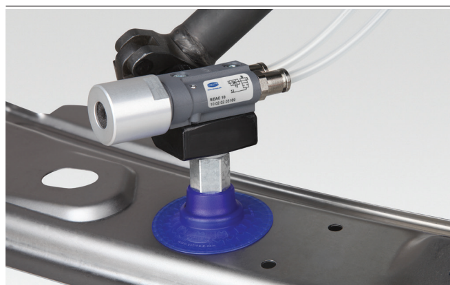
Génération de vide décentralisée avec éjecteurs SEAC directement à la ventouse
