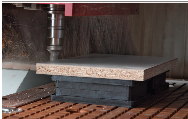
Bloc de bridage par le vide VCBL-R lors du bridage d'un panneau d'aggloméré
