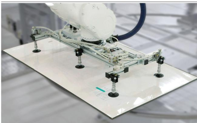
Esempio di montaggio profili di montaggio MO-PROF
